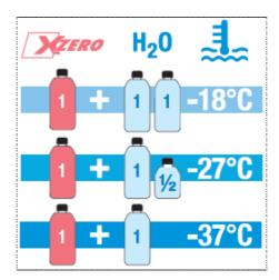
**Xzero G12** è compatibile con acque dure. Usare acqua pulita. Non usare acque reflue provenienti da processi industriali e/o acque marine o salmastre.
